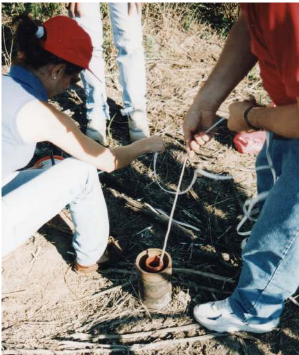
Imagen 5: Medición conductividad eléctrica del agua, Guanacaste, Costa Rica. Marta Paris®.
